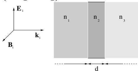
Eine ebene Welle falle senkrecht auf die in der Abbildung gezeigte Zwischenschicht. Die Brechungsindizes der drei nichtmagnetischen Medien seien  $n_1$ ,  $n_2$  und  $n_3$ . Die Dicke der Zwischenschicht sei  $d$ , während die anderen beiden Medien jeweils einen Halbraum füllen.
