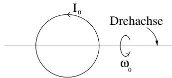
Auf einer reibungsfrei gelagerten Achse sei eine Leiterschleife (Trägheitsmoment  $\theta$ , Fläche  $A$ ) montiert, in der ein Gleichstrom  $I_0$  aufrecht erhalten wird. Die Achse rotiere zunächst mit der konstanten Winkelgeschwindigkeit  $\omega_0$ .
