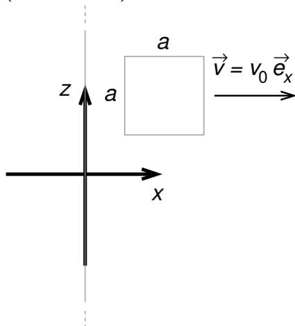
Gegeben sei ein unendlich langer, dünner Draht entlang der  $z$ -Achse eines kartesischen Koordinatensystems, der den konstanten Strom  $I$  trage.
