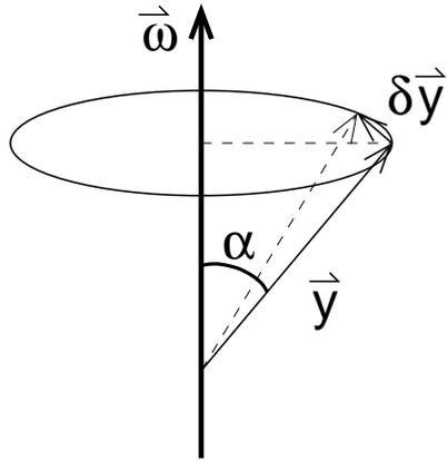
**Abbildung 1.4:** Änderung  $\delta\vec{y}$  von  $\vec{y}$  nur aufgrund der Rotation mit Winkelgeschwindigkeit  $\vec{\omega}$ .
