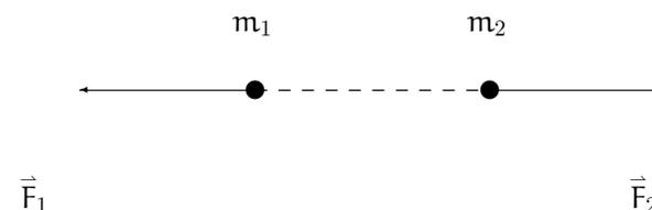
Im (abgeschlossenen) 2-Teilchensystem ist nach Gl. (1.4) und Gl. (1.5)  $\vec{F}_1 + \vec{F}_2 = 0$ . Wenn das Kraftgesetz in jedem Koordinatensystem gleich lauten soll (siehe Kap. 1.1), so ist es von der Form einer Zentralkraft
