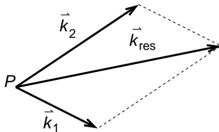
Die resultierende Kraft ergibt sich durch Parallellogrammkonstruktion. Umgekehrt lassen sich Kräfte genauso in Komponenten zerlegen.
